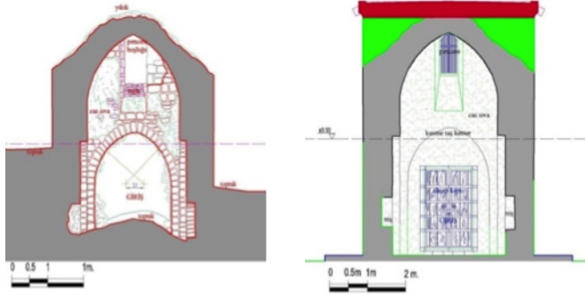
Görsel 272-273. Surp Diziranavor Kilisesi B-B Boy Restorasyon Kesiti (Ş. Öztürk)
