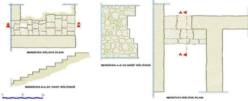
Görsel 34. Müştemilat Servis Bölümü Dam Başı Merdiven Rölöve Plan ve Kesiti (Ş. Öztürk)
